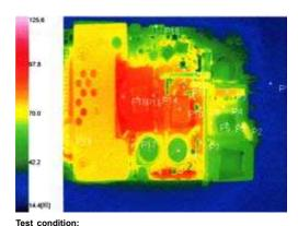
Test condition: M/N : SNP-Z106-M, Input : 244V Output : 5V/20A, Ambient : 23.5°C
