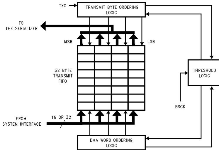
FIGURE 3-9. Transmit FIFO
