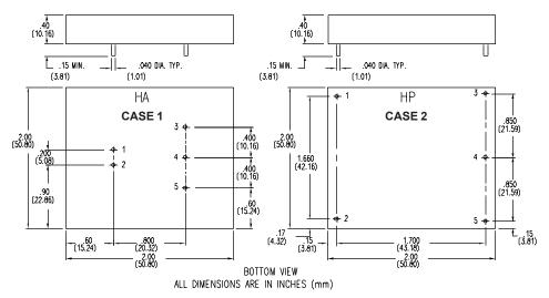
Pins 0.040 (1.0) dia x 0.20 (5.1) lg min.
