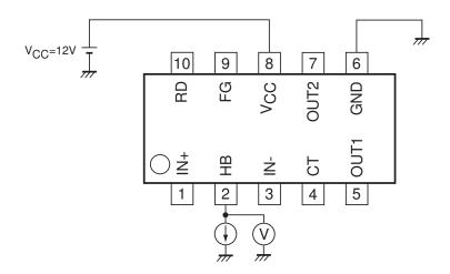
FG, RD input pin L voltage (VFG, RD)
