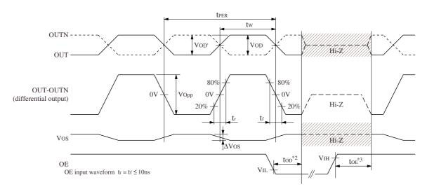
$$\begin{split} DUTY &= t_W/t_{PER} \times 100 \text{ (\%) @ crossing point} \\ \Delta V_{OD} &= |V_{OD}{}^{'} - V_{OD}| \end{split}$$
