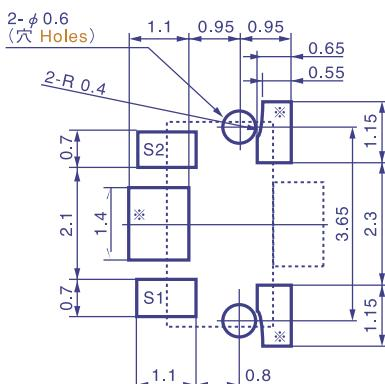
※金属ケースダミーパターン Metal case dummy pattern
