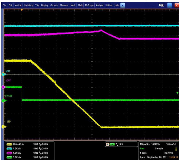
Figure 12. ILED Rampdown (ILED_OUT=1.0A)
