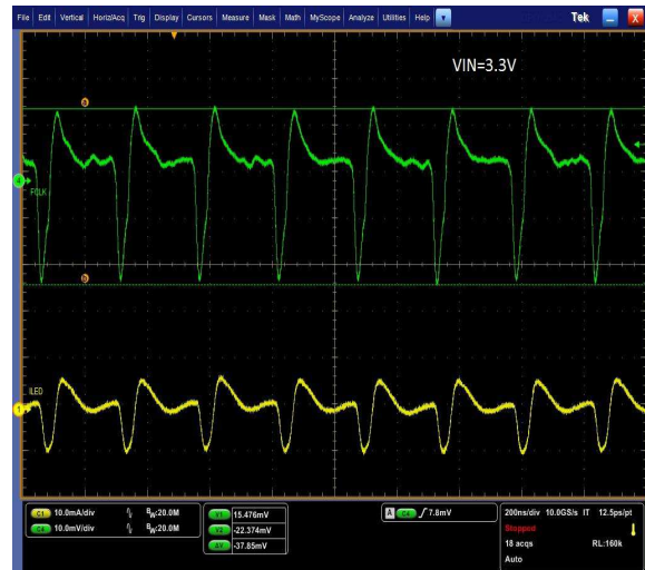
Figure 11. VOUT / ILED_OUT ripple, ILED_OUT = 1.0A
