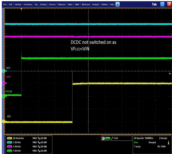
Figure 10. ILED Startup (ILED_OUT=60mA)
