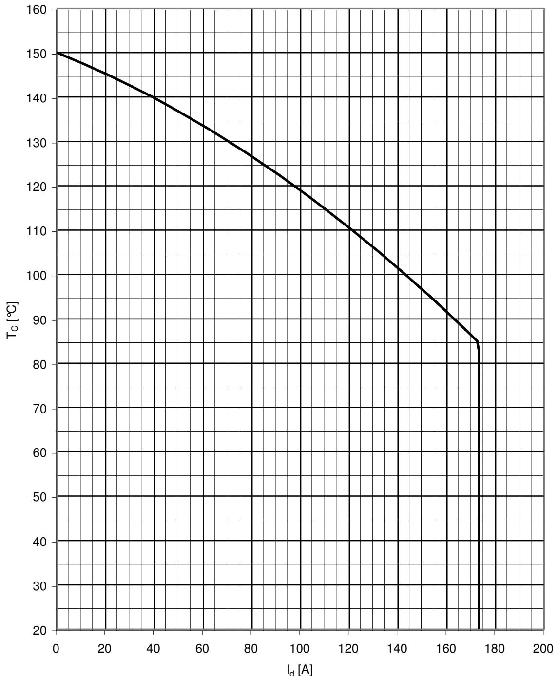
Höchstzulässige Gehäusetemperatur / Maximum allowable case temperature  $T_c = f(I_d)$
