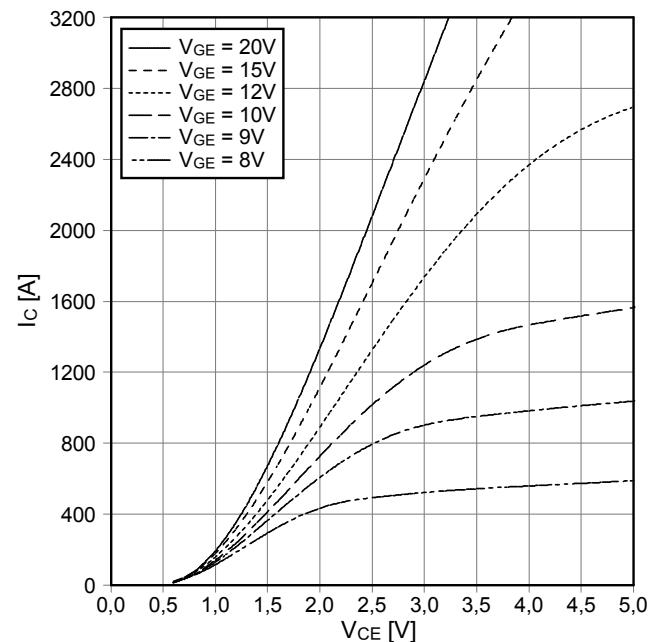
**Übertragungscharakteristik IGBT-Wechselrichter (typisch)**
