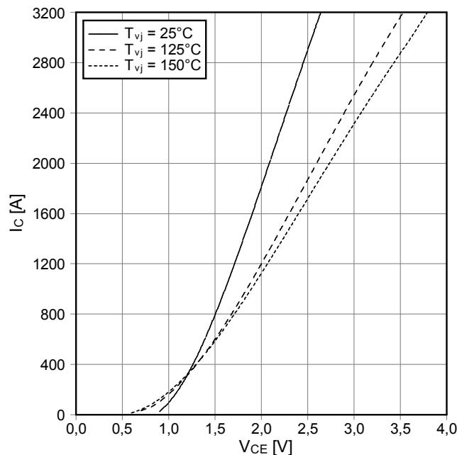
**Ausgangskennlinienfeld IGBT-Wechselrichter (typisch)**
