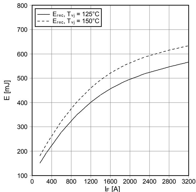
Schaltverluste Diode-Wechselrichter (typisch)
