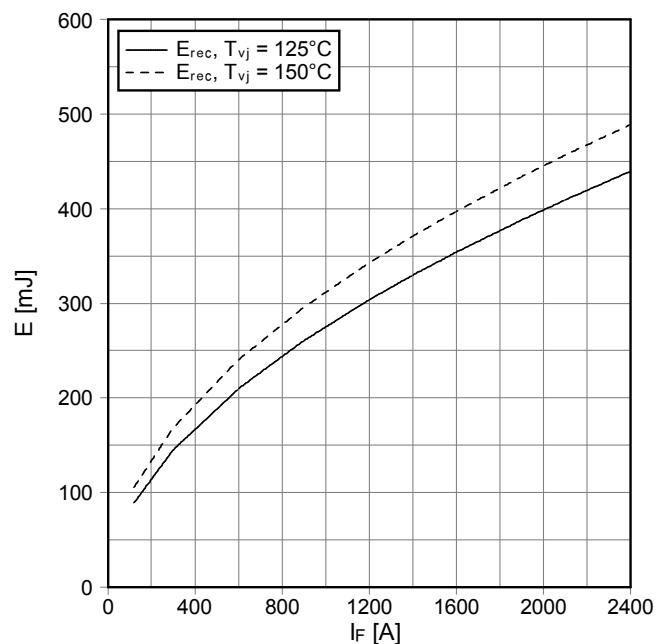
Schaltverluste Diode-Chopper (typisch)
