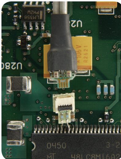
InfiniiMax ZIF tip soldered on board
